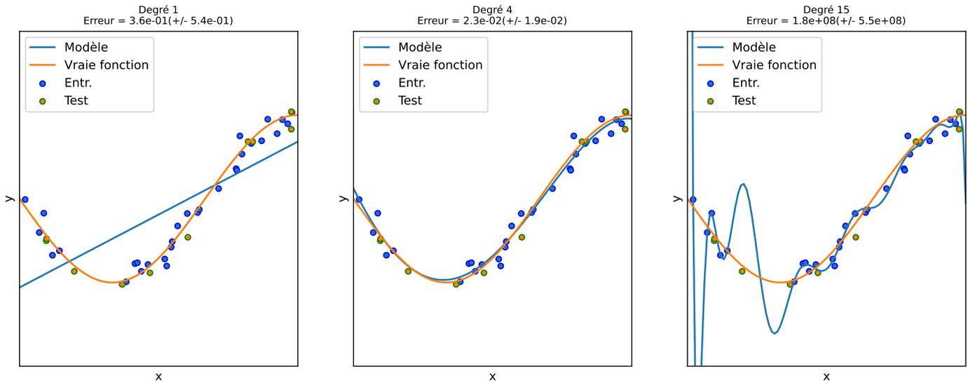
FIGURE 6.1 – Exemples de sur et sous-apprentissage.
