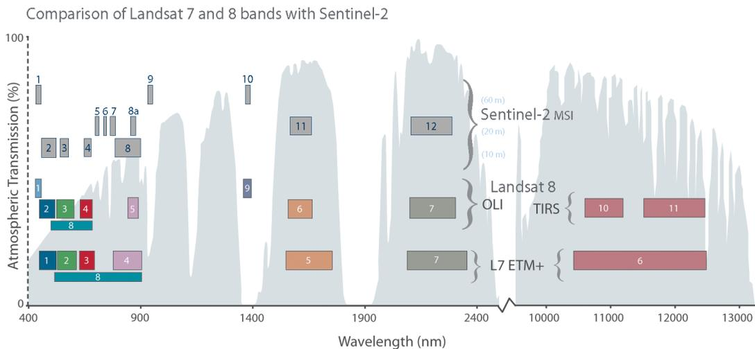
FIGURE 4.1 – Positions des bandes spectrales pour quelques capteurs ([source](#))
